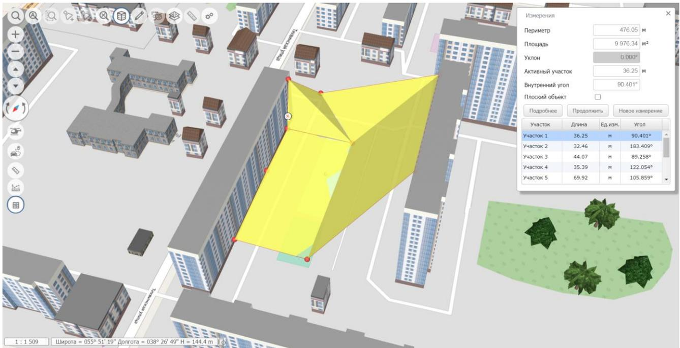
Рисунок 114 Измерения площади объекта сложной формы
