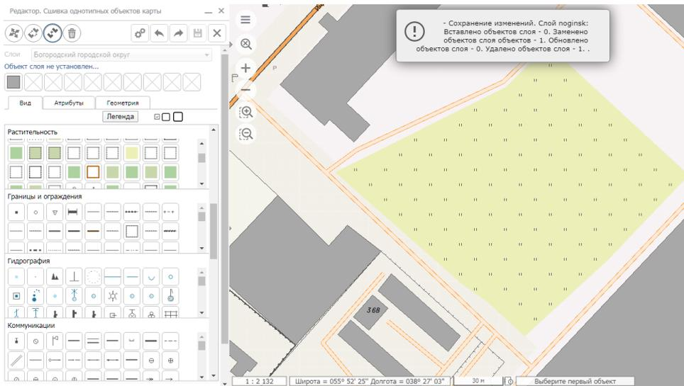
Рисунок 78 Режим сшивки объектов, результат выполнения
