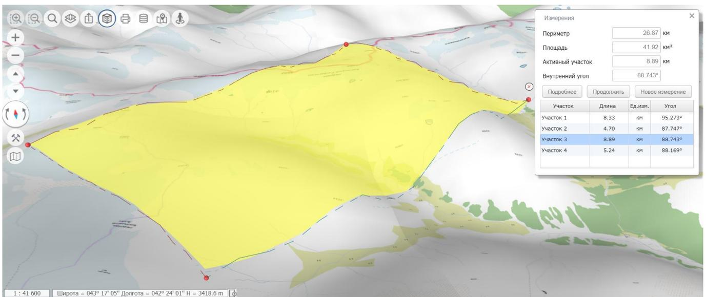
Рисунок 116 Измерения площади объекта по рельефу
