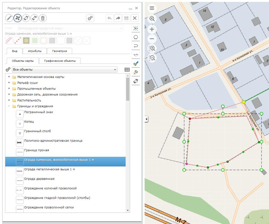
Рисунок 58 Захват точки близлежащего объекта
